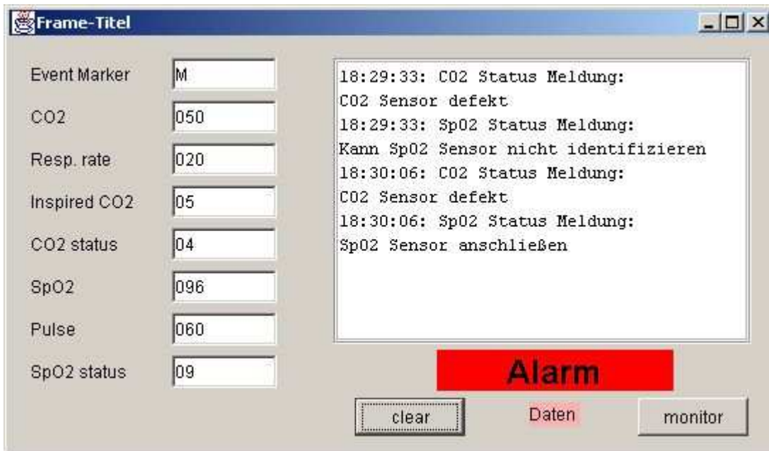
Abbildung 6.3: Bildschirmanzeige am Auswertungs-PC mit Alarmen
